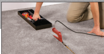
Bandeja de almacenamiento con placas de nylon que actúa como pesa para uniones
