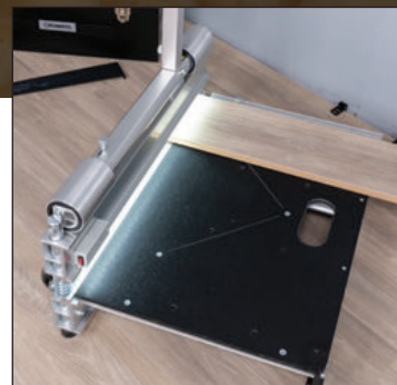
La guía de corte permite realizar cortes rectos o en ángulo
