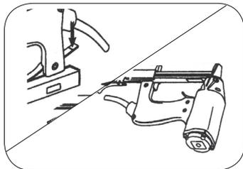
Inserte una tira de sujetadores en el cargador. Verifique la ubicación de la corona de las grapas en el cargador.
