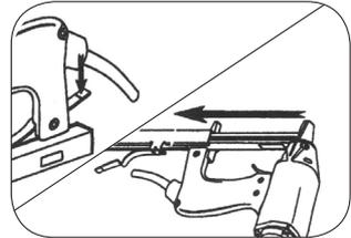
Insérez une bande d'agrafes dans le chargeur. Assurez-vous que la couronne de l'agrafe repose sur le chargeur.
