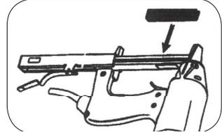
Poussez le couvercle du chargeur vers l'avant jusqu'à ce qu'il s'enclenche dans le loquet.
