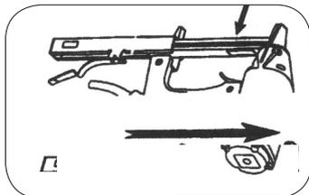
Empuje la cubierta del cargador hacia adelante hasta que el pestillo enganche en el lugar.
